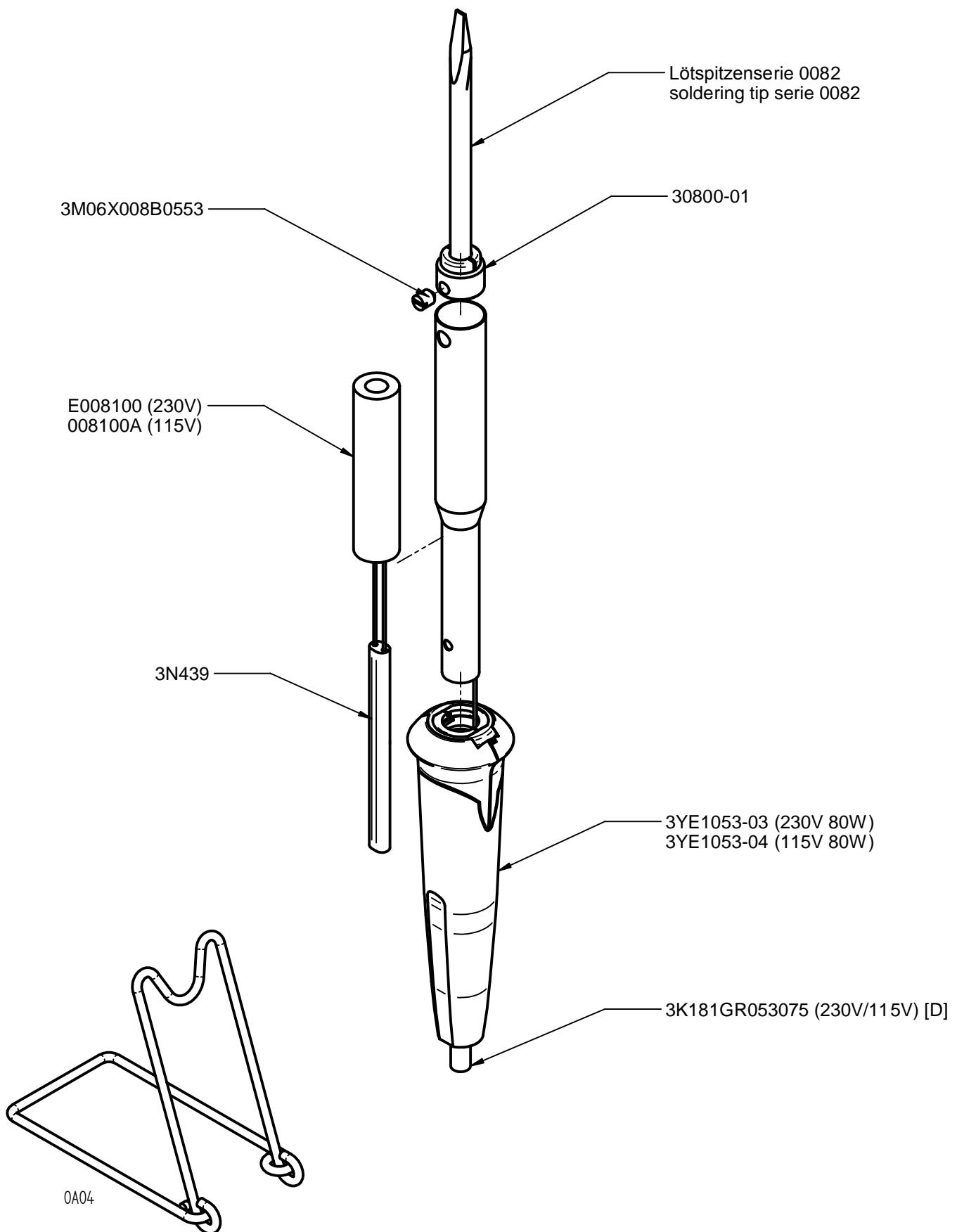
Der eingebaute Heizkörper muss der auf dem Griff angegebenen Spannung entsprechen.
